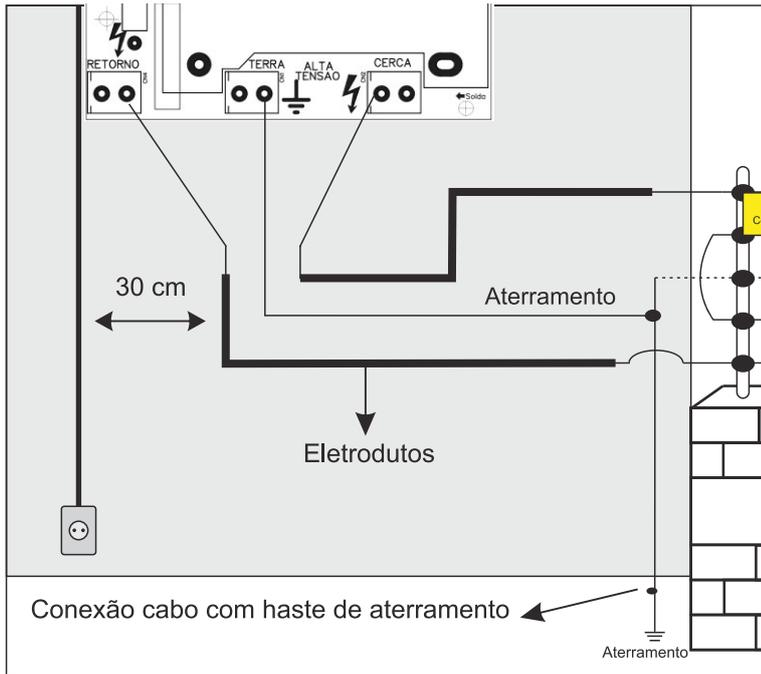
CONEXÃO DOS BORNES
